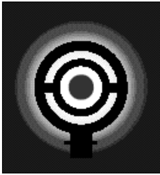
Spindelvæsvirkningen, kan fjernes ved at flytte bageste sigtemiddel frem og tilbage.
