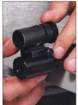
Kontroller altid om ringkornet sidder fast, inden du starter med at skyde.
