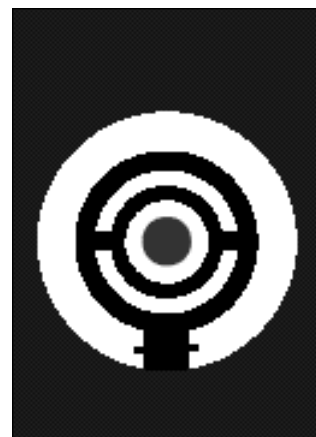
Bageste sigtemiddel er den store sorte flade, forreste sigtemiddel er selve de mørke ringe, og skiven er den slørede plet.
